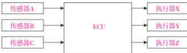
图 1-11 电控汽油喷射系统的组成
